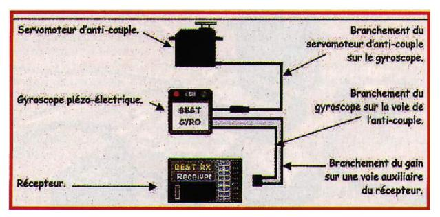
Le gyroscope s'intercalera entre le servomoteur d'anticouple et le récepteur. La deuxième prise du gyroscope se branchera sur une voie auxiliaire du récepteur et servira au réglage du gain.
