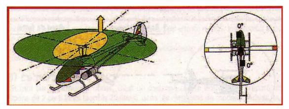
La précession gyroscopique fera qu'elle ne s'inclinera qu'un quart de tour plus loin, donc en avant. Lorsque la palette passe à l'arrière, son incidence revient à  $0^{\circ}$ .
