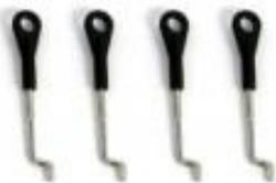
Le réglage se fait en allongeant ou en raccourcissant la biellette. La chape à rotule se visse et se dévisse. Attention de ne pas trop dévisser pour ne pas que les 2 parties se séparent en plein vol. On recommande de laisser au minimum 3 tours comme marge de sécurité.
